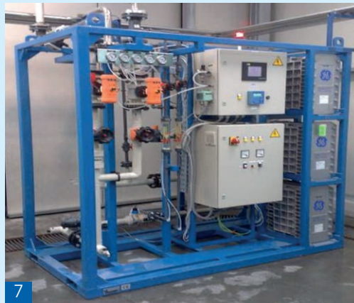
8 Sistema de ultrafiltración para el la reutilización de agua de rechazo
